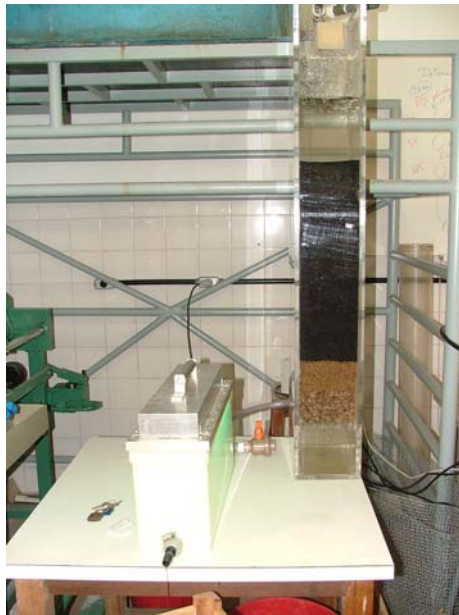
FIGURA 8 - Tratamento da água de chuva, com carvão ativado, como meio filtrante, e desinfecção com ultravioleta.
