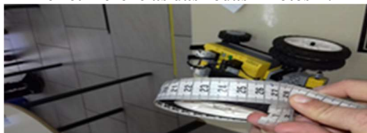
Figura 5– Ilustração dos testes realizados na comprovação dos cálculos de Velocidade Média e as circunferências das rodas – Fotos E.
