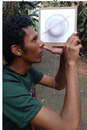
Figura 2 - Medição do ângulo com o teodolito.
