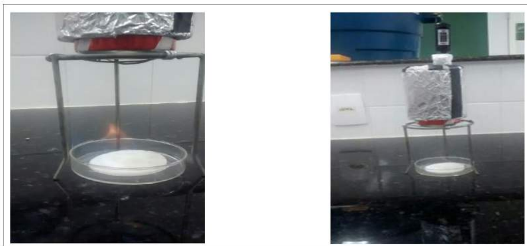
Figura 1: Queima do algodão com o óleo, aquecendo a lata com água (esquerda) e aparato experimental com lata, isopor e termômetro na parte superior (direita).
