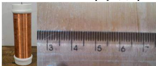
Figura 3 - Bobina Secundária utilizada no projeto, e, espessura do fio usada.
