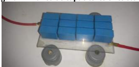
Figura 1 - Banco de capacitores e resistores.
