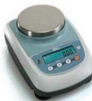
Imagem 3: balança semi analítica
