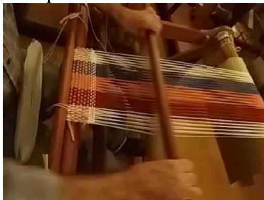
Figura 4 – Vai e vem do pente que ao retornar para o ponto de partida deve ser alternado seu ponto de repouso sendo em cima e embaixo.
