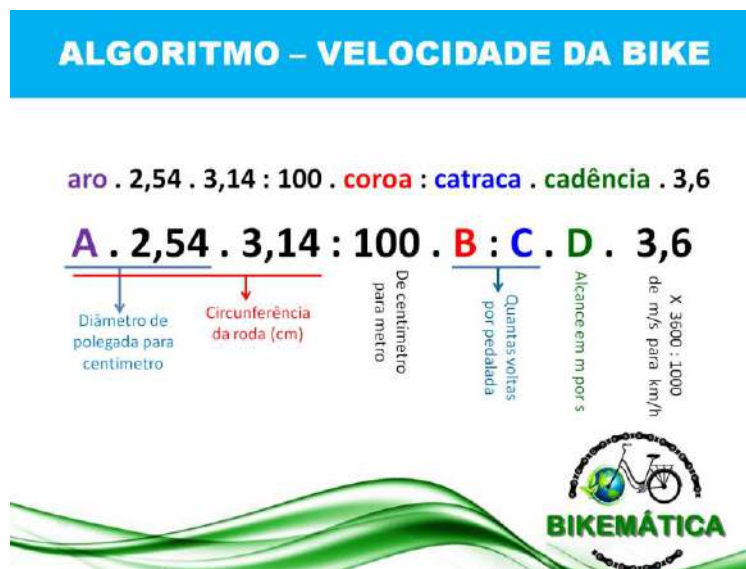
Figura 2 – Algoritmo para determinação da velocidade da bike de acordo com o aro, coroa, catraca e cadência do ciclista.
