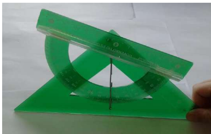
FIGURA 2: TEODOLITO COM ESQUADRO DE 45°
