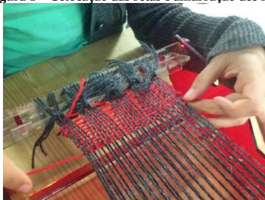
Figura 1 – Colocação das retas e amarração dos fios.
