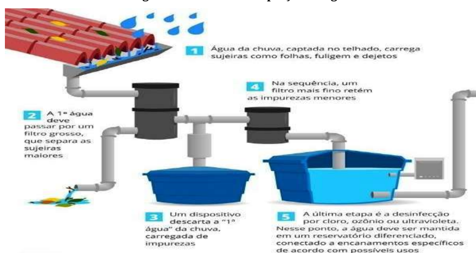
Figura 1 – Sistema de captação da água.
