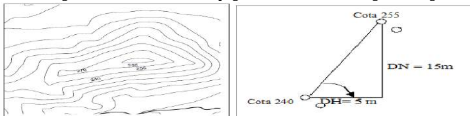
Figura 4 – Recorte da carta topográfica e valores no triângulo retângulo
