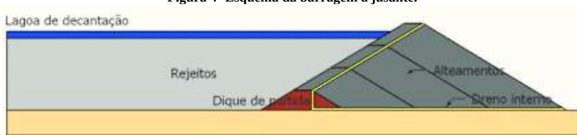
Figura 4- Esquema da barragem a jusante.
