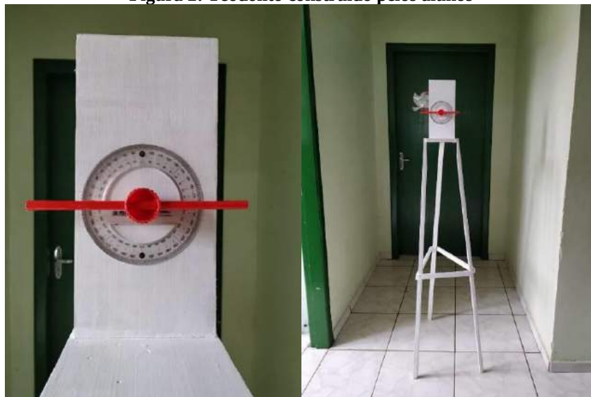
Figura 2: Teodolito construído pelos alunos
